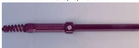
Kyslíková elektroda samopolarizační
